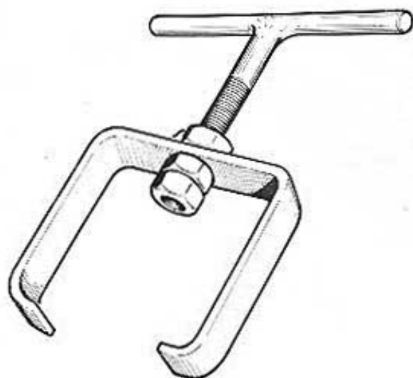
0.7 - Outil pour la contraction du ressort d'embrayage.
