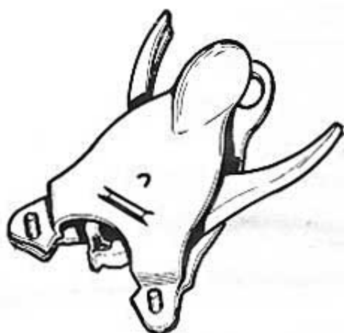
0.61 - Pince pour pose et dépose des segments sur le piston.
