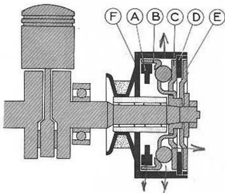
Le disque d'embrayage (D) est cranté pour être rendu solidaire du tambour extérieur (F) qui reçoit par l'intermédiaire de la poulie, la courroie de transmission.
