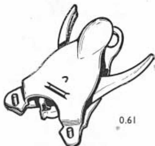
Pince pour démontage et remontage des segments sur piston
