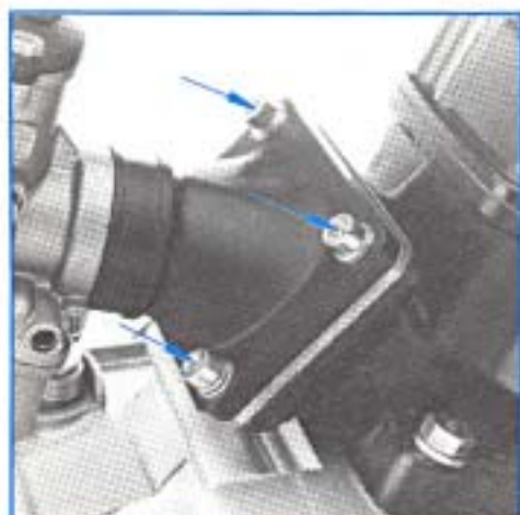
Vis de fixation de la boîte à clapet : 1,8 m.daN
