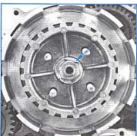
Ecrou de fixation de l' embrayage : 5,5 m.daN
