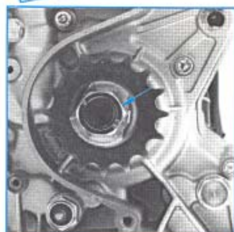
Ecrou de fixation du pignon de sortie : 6 m.daN
