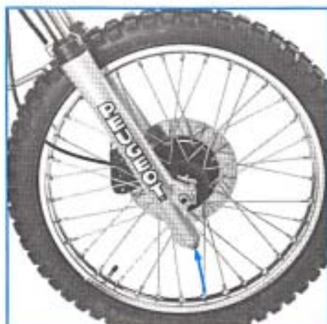
Vis de fixation des tubes inférieurs de fourche : 4,5 m.daN
