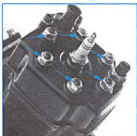
Ecrous de fixation de la culasse : 2 m.daN
