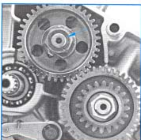
Ecrou de blocage du pignon d'arbre d'équilibrage : 5 m.daN
