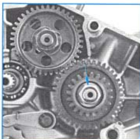
Ecrou de blocage des pignons de vile- brequin : 5,5 m.daN
