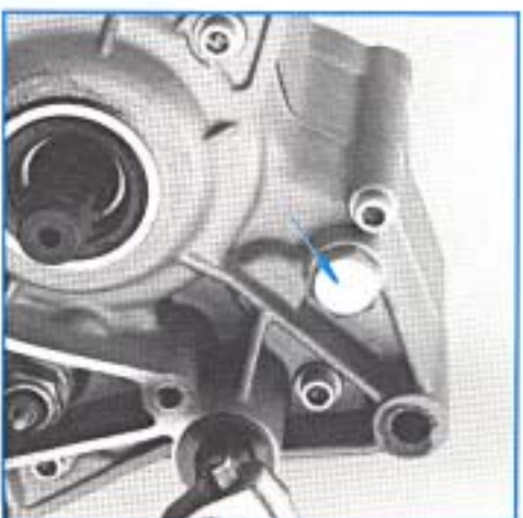
Vis butée du ressort de lanceur : 1,8 m.daN
